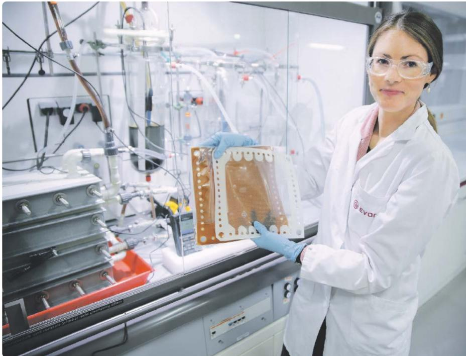
Prozessentwicklerin Blank-Shim zeigt die bipolare Membran (braun) und einen Spacer (weiß), der den Abstand zwischen den Membranen hält und durch den die Flüssigkeiten fließen.
