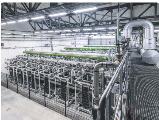
Insgesamt 72 Stacks umfasst der Elektrolyseur am BASF-Standort Ludwigshafen. In drei sogenannten Arrays sind die einzelnen Elektrolysemodule miteinander und mit dem H<sub>2</sub>-Verbundnetz am Standort verknüpft.
